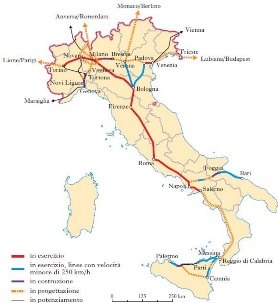
Fig. 2 – Le réseau ferroviaire italien à grande vitesse, avec en rouge les lignes achevées et en bleu les lignes limitées à 250 km/h
